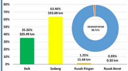
Persentase Kondisi Jalan Nasional Semester 2 Tahun 2020 Provinsi Nusa Tenggara Barat
